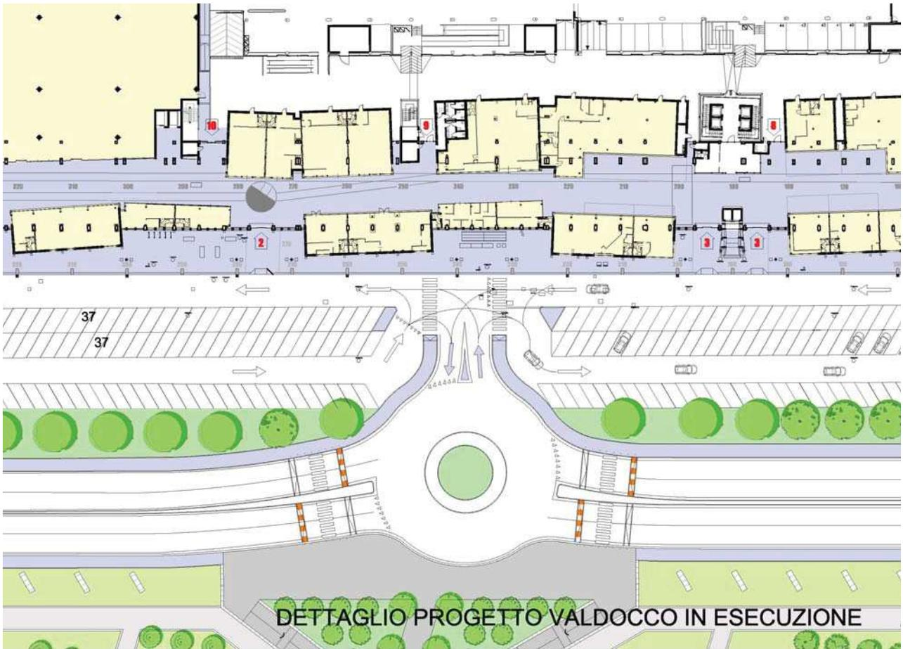
Nello nuovo tracciato del c.so Mortara è stato necessario l'inserimento di una nuova rotonda posta in posizione mediana tra la via Livorno e la p.zza Baldissera, in modo da creare un accesso normato al parcheggio antistante il centro commerciale SNOS, oltre ad attraversamenti rialzati pedonali.
