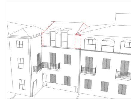
SCHEMA 3\_Arretramento della copertura rispetto ai confini; si sottolinea l'indipendenza volumetrica del nuovo edificato rispetto ai manufatti storici.
