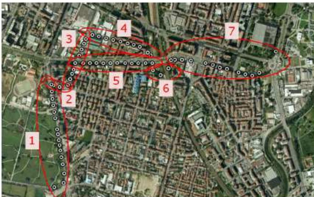
Figura 13. Punti di rilievo dell'indagine sismica (a); indicazioni delle sezioni riportate al capitolo 9 (da "Rapporto interpretativo dell'indagine" di Citiemme s.r.l., settembre 2012)
