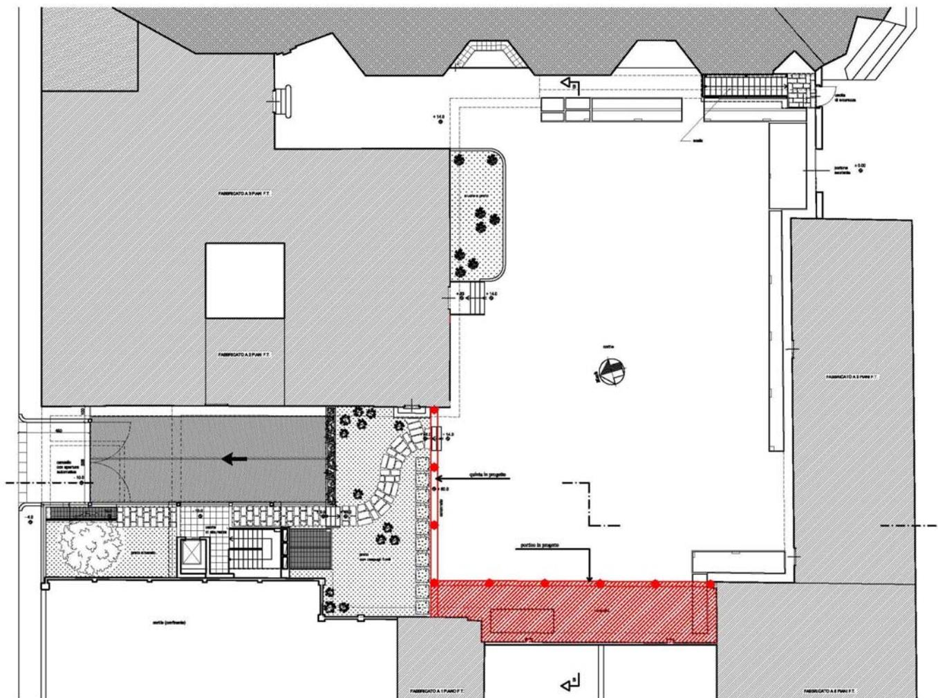
SITUAZIONE IN PROGETTO: ricostruzione del portico e della quinta architettonica come a suo tempo concordato con la Soprintendenza
