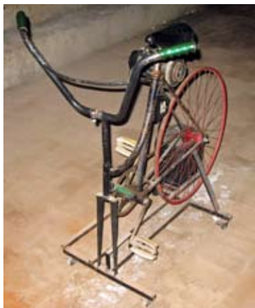
La dinamo a pedali per l'illuminazione o, secondo altri, per il ricambio d'aria (archivio 4 a Circoscrizione 2009)
