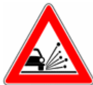
Figura II.390 - Art. 31 MATERIALE INSTABILE SULLA STRADA
