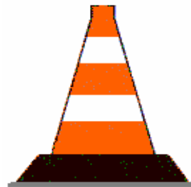
Figura II 396 - Art. 34 CONO Il cono deve essere usato per delimitare ed evidenziare zone di lavoro di breve durata (non superiore ai due giorni), per deviazioni ed incanalamenti temporanei, per indicare aree interessate da incidenti o per la separazione provvisoria di opposti sensi di marcia
