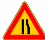
Figura II.386 - Art. 31 STRETTOIA ASIMMETRICA A DESTRA Presegnala un restringimento pericoloso della carreggiata posto sul lato destro per la presenza di un cantiere stradale
