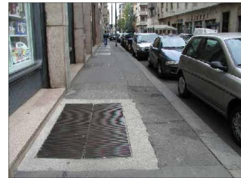
Durante il rifacimento del marciapiede l'impresa dovrà provvedere a mettere in sicurezza le griglie di areazione del piano cantinato di tutte le proprietà private che hanno pertinenza sul marciapiede
