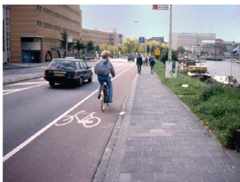
Figura 2 - Due piste ciclabili con corsia riservata ricavata sulla carreggiata, a fianco delle corsie veicolari
