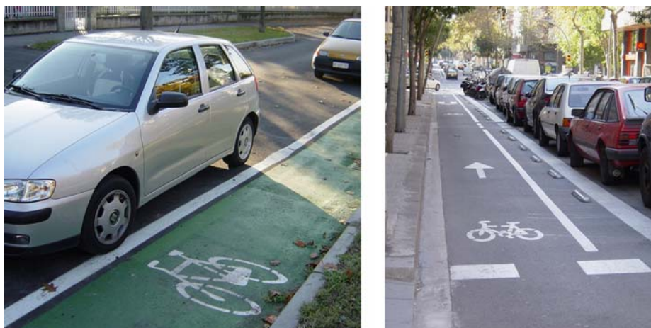
Figura 5 - I percorsi ciclabili devono essere tenuti a distanza dai veicoli in sosta, come nell'immagine a destra, perché l'improvvisa apertura di una portiera può risultare pericolosa
