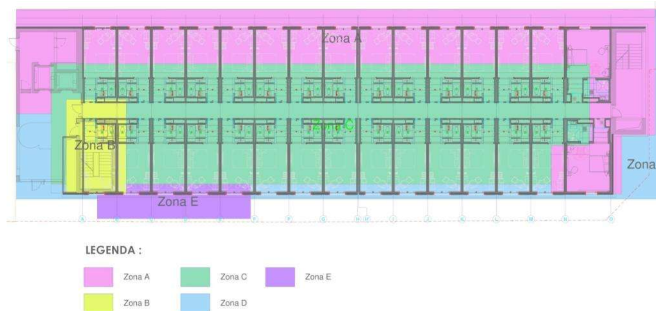
Figura 30 – Zone di scavo- sovrapposizione con planimetria piano terra di progetto
